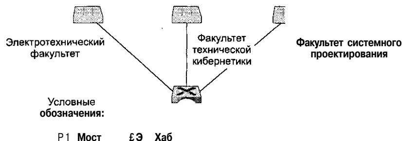
Рис. 5.28. Объединенные сегменты локальной сети с избыточными путями
