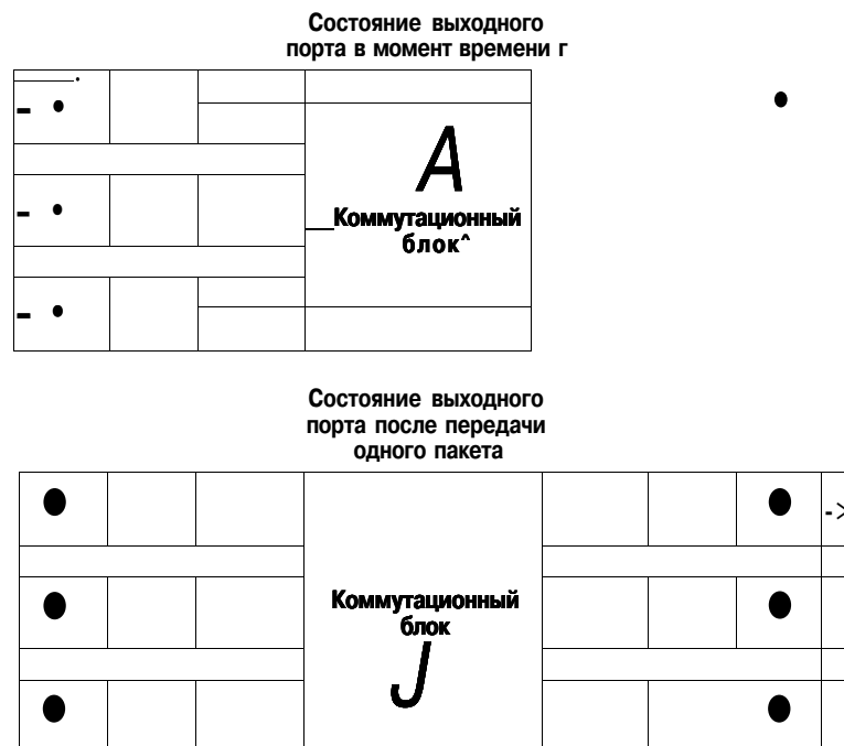
Рис. 4.37. Образование очередей в выходном порту
