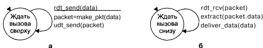
Рис. 3.8. Протокол rdt 1.0 — передача по абсолютно надежному каналу связи: а — передающая сторона; б — принимающая сторона
