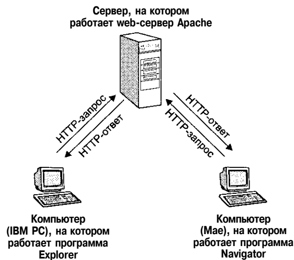
Рис. 2.4. Передача запросов и ответов HTTP
