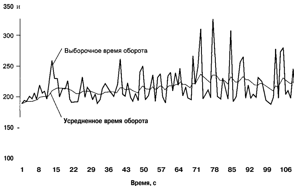
Рис. 3.29. Выборочные значения времени оборота и их весовые средние значения
