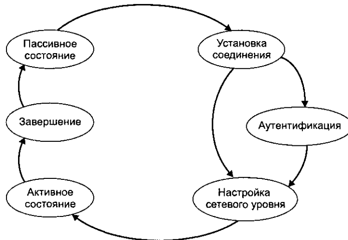
Рис. 5.40. Диаграмма состояний протокола LCP
